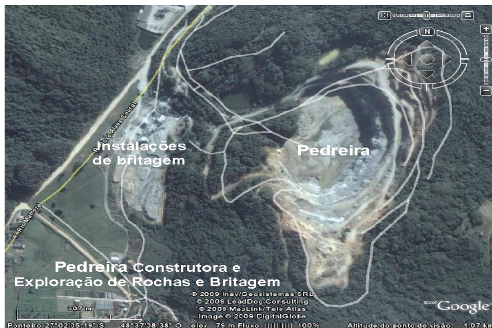
Figura 4.4 - Frente de exploração em bancadas, da pedreira da Construtora e Exploração de Rochas e Britagem, localizada em Camboriú, que explora um granito grosso, cinza.
